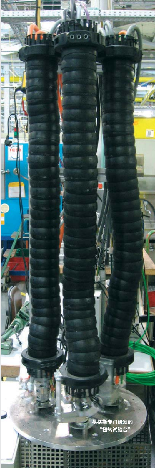
CF ROBOT 在扭转 \pm 270^\circ 的运动中经过三百万次测试
