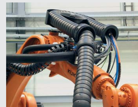
拖链引导线缆靠近机器人本体，而不是缠绕于机器人本体上
