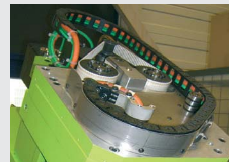
E2 mini, B15 系列 - 主轴电机旋转角度 210°
