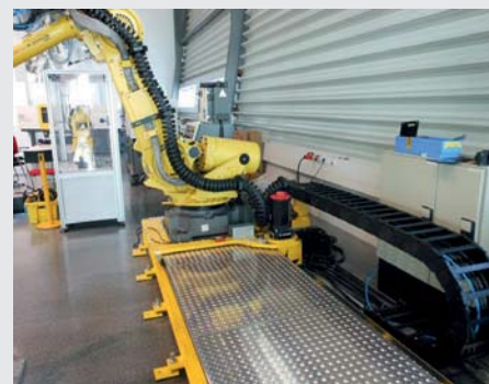
1-6轴使用 Triflex® R 拖链，第 7 轴使用 E4.1 水平拖链的机器人使用示例
