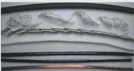
CF ROBOT 经过三百万次双循环后，依然没有损坏
