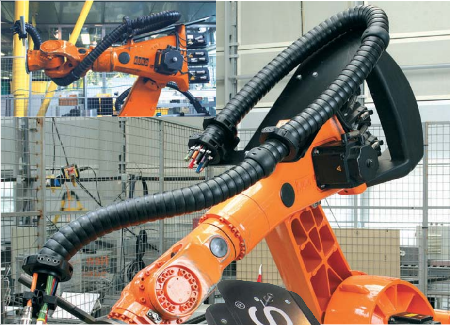
Triflex® RS 系统案例。该 RS 系统用于机器人上以节约运动空间。详细的视频见 ▶ www.igus.com.cn/RS_Film
