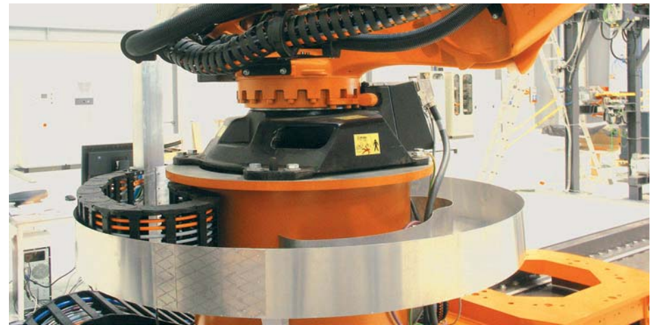
易格斯 RBR 拖链旋转角度 360°，用于机器人
