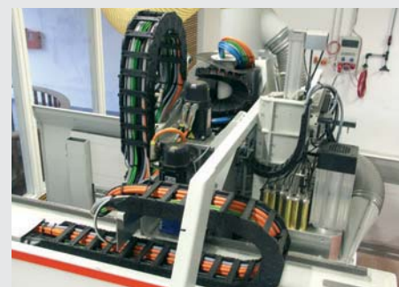
易格斯 TwisterBand 用于木工机械上的五轴切割，安全并节约成本。
