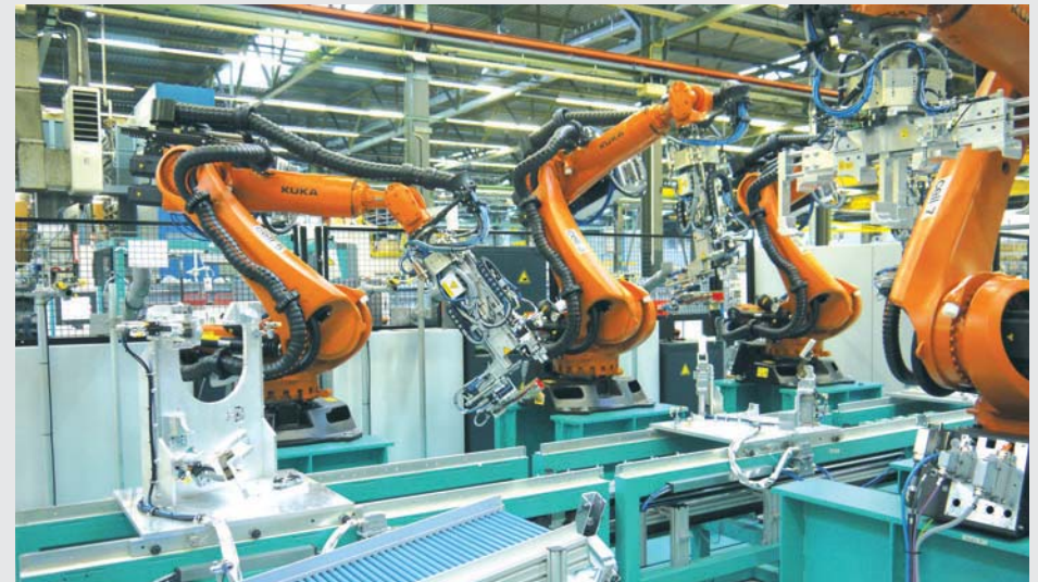
汽车业使用实例，该生产线主要用于生产汽车塑料件。机器人最终用户生产设施中只配备了机器人，易格斯的 RSP 系统为机器人上的线缆提供了全面的保护，并满足了机器人非常高的灵活性要求。
